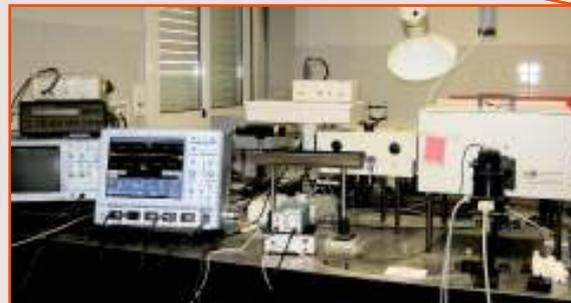
\* Elementos del espectrofotómetro láser
